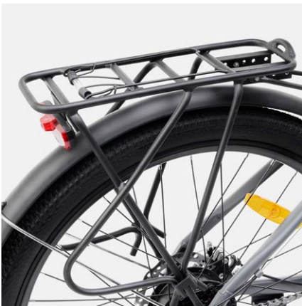
Porte-bagages arrière installé
