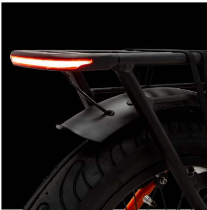
Portapacchi posteriore con luce freno integrata
