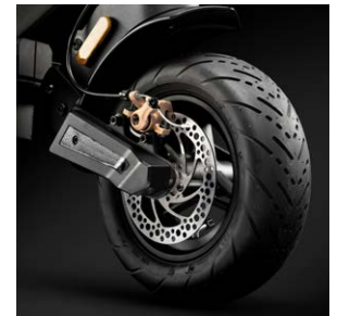
Freno a disco anteriore ed elettronico e a disco posteriore
