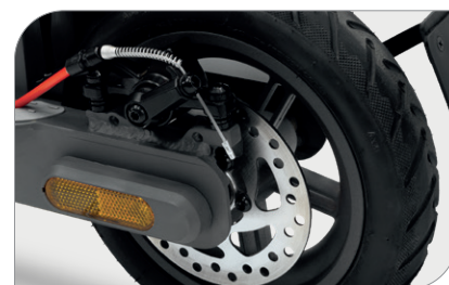
Sistema frenante con tecnologia KERS integrata
