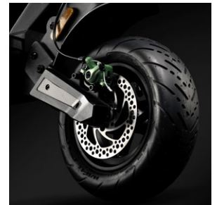
Frein à disque avant, frein électronique et frein à disque arrière
