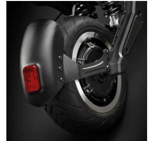
Moteur 500W, Puissance de crête : 900W
