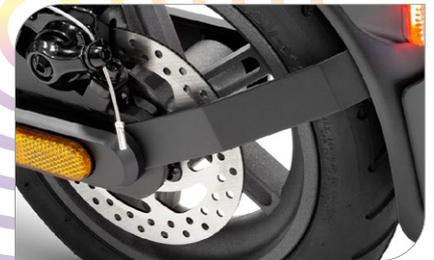
Frein électronique à l'avant, à disque à l'arrière, avec 2 leviers de freins
