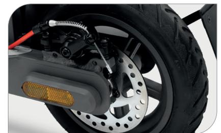
Système de freinage avec technologie KERS intégrée
