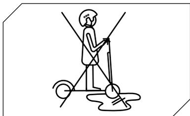
Nejezděte s elektrickou koloběžkou v kalužích a na mokřém povrchu.
