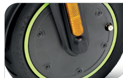
Motore brushless 300 W, 16 Nm
