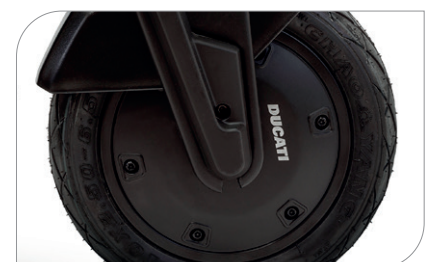
Motore brushless 350 W, 18,9 Nm
