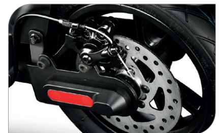
Sistema frenante con tecnologia KERS integrata
