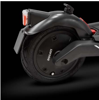
Moteur 500W, 28Nm Puissance de crête : 800W
